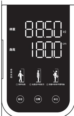
**体重测量：**测量者上秤后保持身体稳定，无晃动情况下 2 秒内可完成体重测试，并在 LED 面板上显示体重信息，如图所示为 88.50kg。
